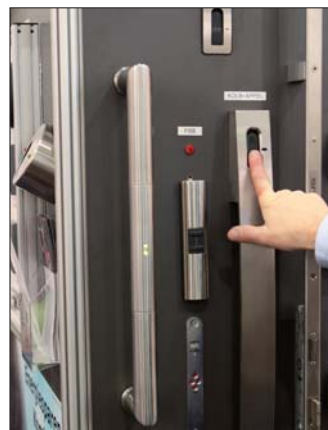
Biometrische Zutrittskontrolle mittels Fingerscanner.
