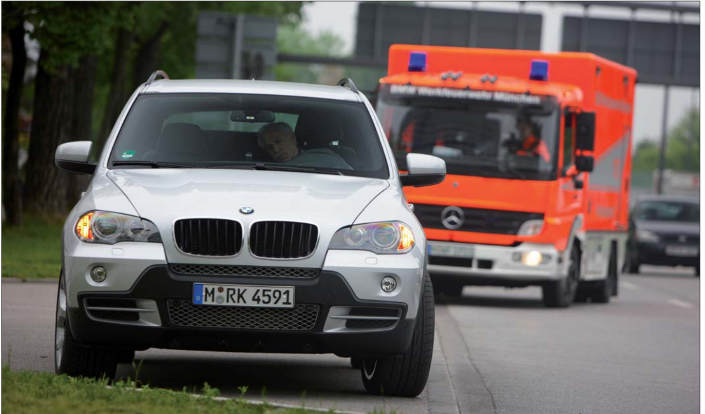
Testfahrt mit dem BMW-Nothalte-Assistenten im Rahmen eines Forschungsprojekts: Wird der Fahrer bewusstlos, steuert das Nothaltesystem das Auto an den Fahrbahnrand.
