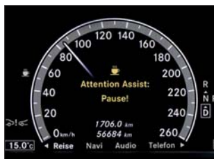
„Attention Assist“: Registriert das System Müdigkeitssymptome beim Lenker, gibt es ein Warnsignal.
