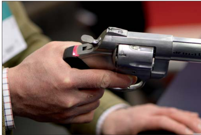
Sicherheit am Schießstand: Die Schussabgabe wird verhindert, wenn die Richtung zur Scheibe nicht eingehalten wird.
