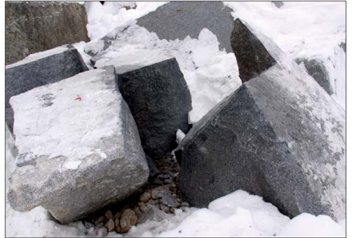
Neues Steinsprengverfahren: Steinblock vor der Sprengung mit Elektrozündung; Teile nach der Sprengung.
