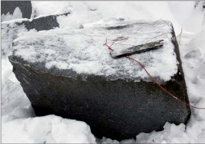
Neues Steinsprengverfahren: Steinblock vor der Sprengung mit Elektrozündung; Teile nach der Sprengung.
