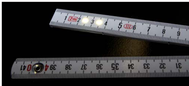
Leuchtmeter: Zwei Leuchtdioden in einem Gliedermaßstab.
