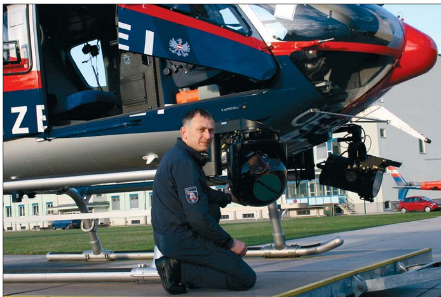
Moderne Polizeiausrüstung: Eine Nachtsichtkamera liefert Bilder in das Cockpit, ein Hochleistungsscheinwerfer leuchtet das Zielgebiet aus.
