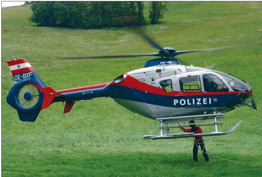
Seilbergung: An einer Zwischenlandestelle steigt der Flight-Operator aus und hängt sich mit dem eigens entwickelten „Doppellasthakensystem“ am Hubschrauber an.
