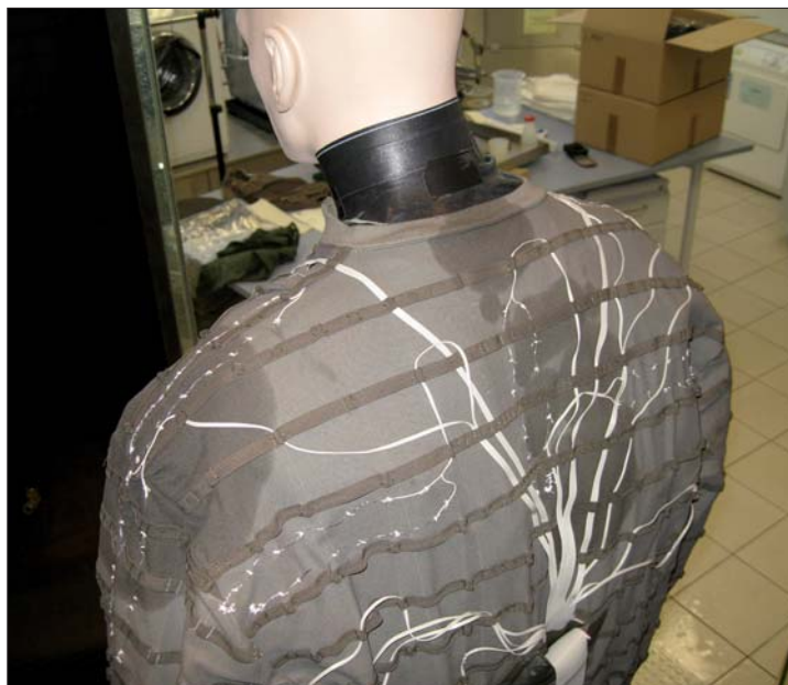
Wasserflecken nach künstlicher Beregnung: Die Dichtigkeit der Polizei-Regenjacke wird genau geprüft.
