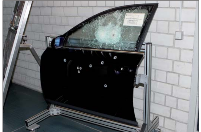
Ballistische Materialprüfung: Auch Sonderschutzfahrzeuge und Sicherheitsgläser werden im Beschussamt Ulm geprüft.
