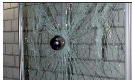
Kugelfallversuch: Prüfung der Durchwurffhemmung einer Verglasung.
