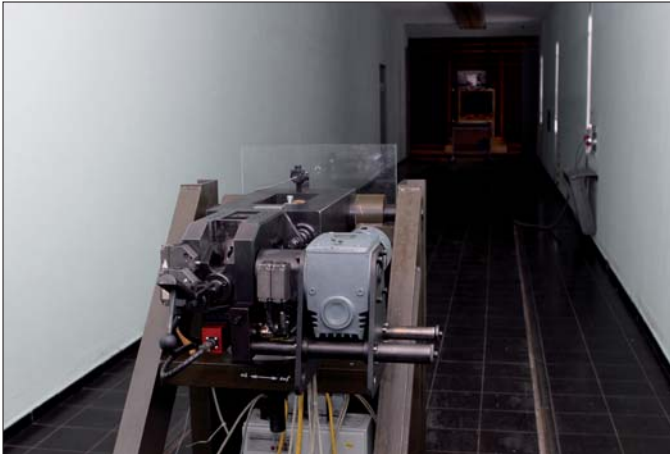
Beschussvorrichtung: Jährlich werden in Ulm etwa 250.000 erlaubnispflichtige Waffen geprüft.
