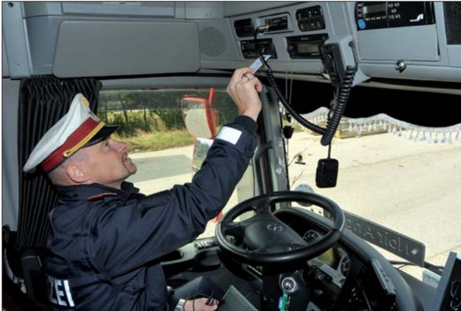
Lkw-Kontrollen: Mit Datensteckern können Polizisten die Daten über die Lenkzeiten herunterladen und auswerten.
