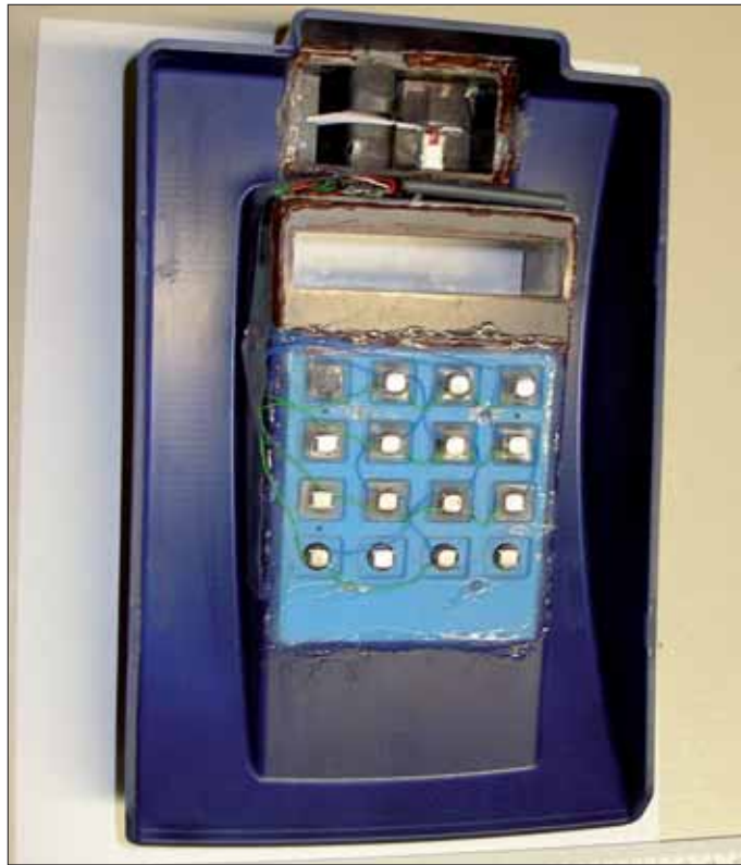
Manipulierte Bankomatkasse: Die Täter schieben eine Art Maske über eine herkömmliche Bankomatkasse. In der Maske befindet sich ein Lesegerät, das die Daten des Magnetstreifens und den vom Benutzer eingegebenen Code speichert.
