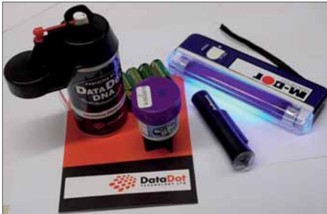
Kontroll-Sets der Polizei bestehen aus UV-Lampen und Lupen mit hundertfacher Vergrößerung.
