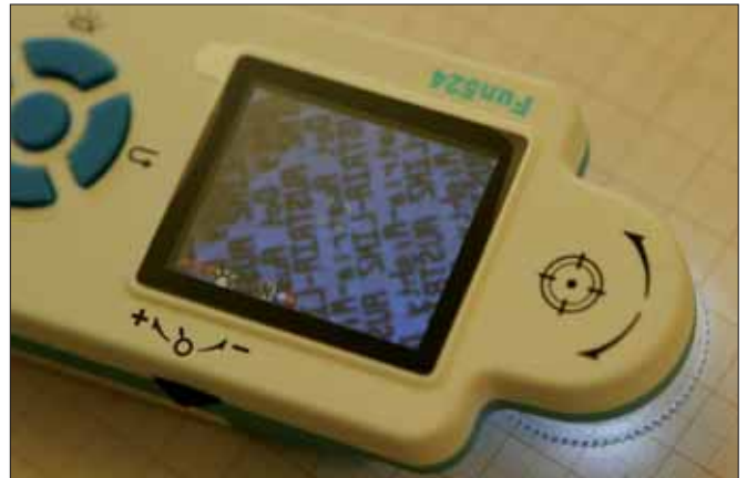
Der Code auf dem Mikropunkt ist nur mit einer Lupe oder einem speziellen elektronischen Lesegerät erkennbar.
