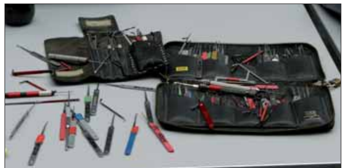
Pick-Werkzeug für das Öffnen von Schließzylindern.
