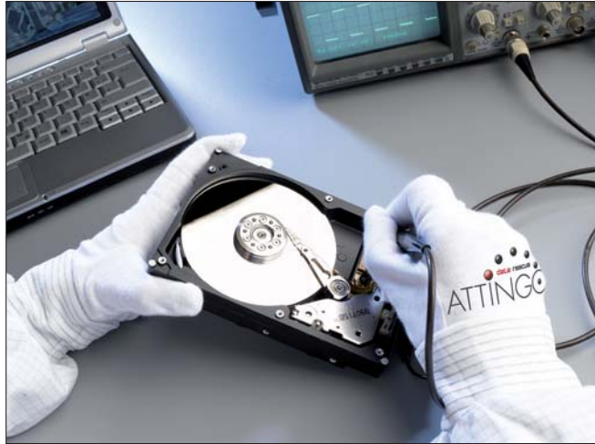
Öffnen einer Festplatte im Reinraum.
