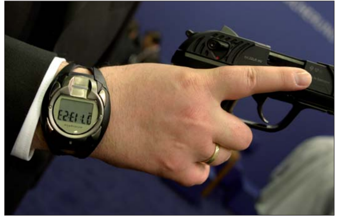
Smart-Gun mit Sensor: Kann nur vom berechtigten Besitzer zum Schießen verwendet werden.
