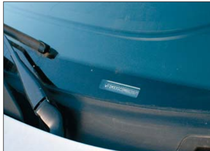
Die Fahrgestellnummer ist das zuverlässigste Merkmal eines Autos.
