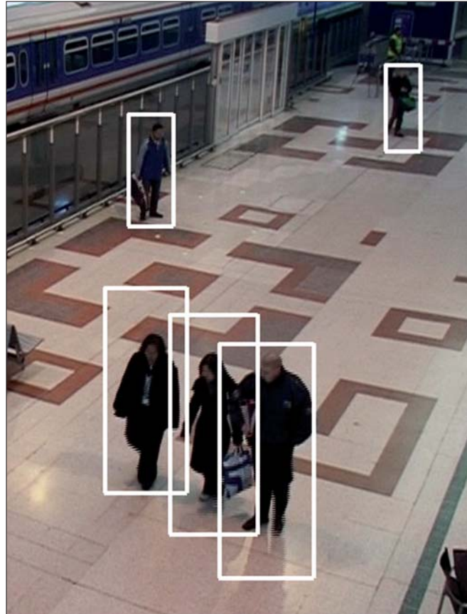
Intelligente Videokameras erkennen selbstständig Personen und „verfolgen“ sie automatisch, wenn sie sich fortbewegen.
