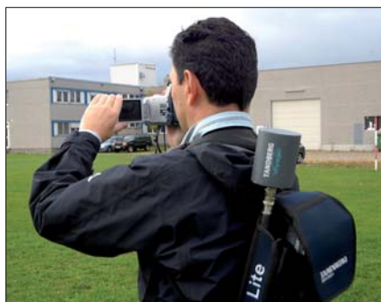
Kamera und Rucksacksender zur mobilen Übertragung von Livebildern.
