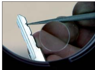
Druckmarken: Ansatz für die Herstellung eines Schlüssels.
