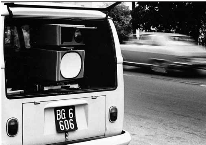
Radarmessgerät in den 60er-Jahren: Die analoge Kamera konnte bis zu 800 Bilder speichern.
