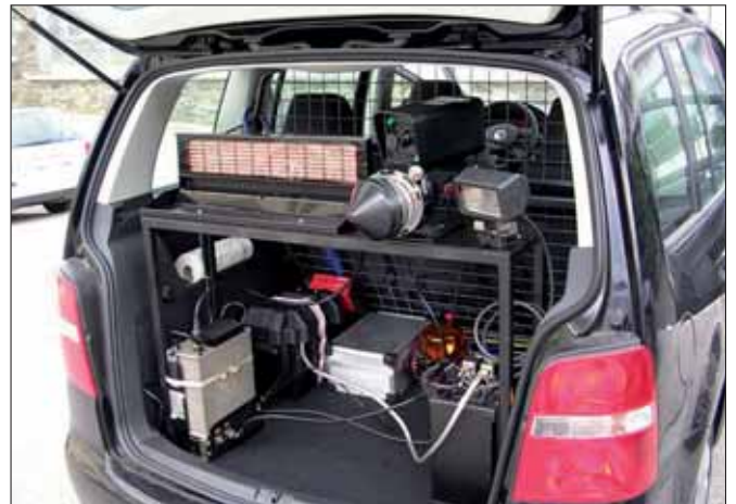
Digitales Radargerät heute: Auf der Festplatte des Computers haben bis zu 40.000 Bilder Platz.
