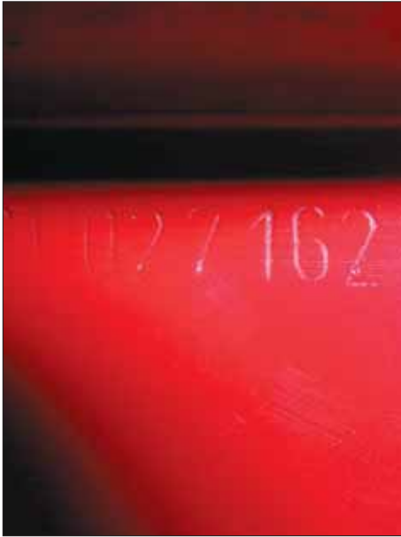
Nachgeschlagen: Manipulierte Fahrgestellnummer im Motorraum.
