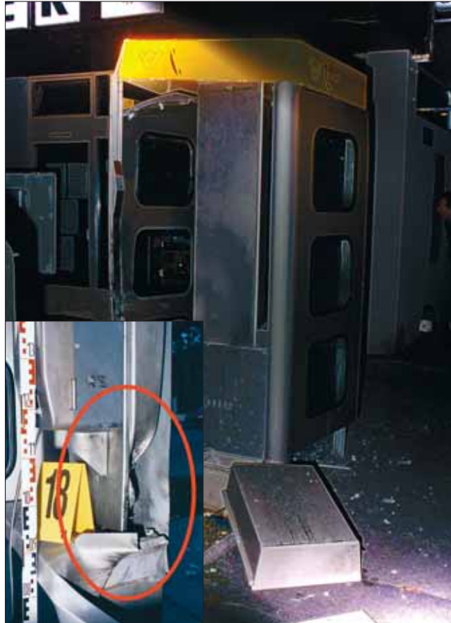
Die Stelle mit den stärksten Beschädigungen und Schmauchspuren weisen auf den Ablageort (Telefonbuchablage) des Sprengkörpers hin.
