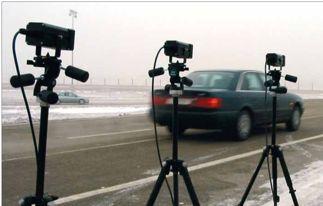
Das System erkennt Kennzeichen von Fahrzeugen, auch wenn diese mit 180 km/h vorbeifahren.
