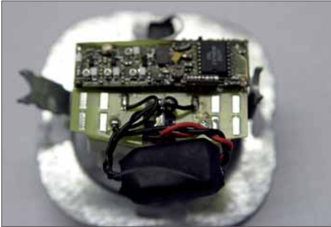
Manipulierte Elektrosteckdose: Abhörgeräte können überall versteckt sein.
