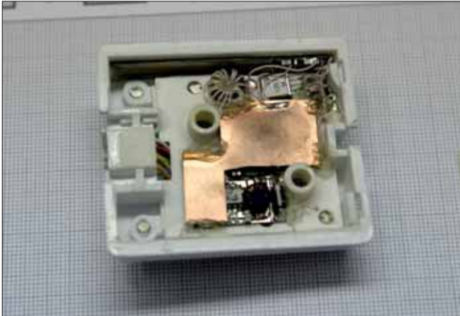
Späh- und Lauscheinrichtungen werden oft in „unverdächtigen“ Gegenständen installiert wie Telefonverteiler.
