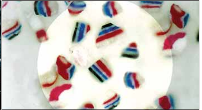
Mikro-Farbcodeteilchen: Unter dem Mikroskop erkennbar.
