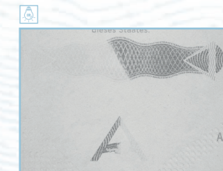
43. Infrarot Absorption Ein Teil des Stichtiefdrucks ist nicht sichtbar unter IR Licht 43. IR dropout A part of the intaglio printing is not visible under IR light
