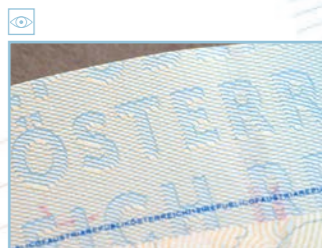
49. Wasserzeichen „Edelweiß“ sichtbar im Durchlicht individuell positioniert 49. Watermark In transmitted light, the individually positioned "edelweiss" becomes visible
