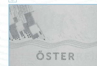
42. Infrarot Absorption Ein Teil des Stichtiefdrucks ist nicht sichtbar unter IR Licht 42. IR dropout A part of the intaglio printing is not visible under IR light
