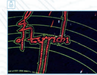
42. Infrarot Absorption Ein Teil des Stichtiefdrucks ist nicht sichtbar unter IR Licht 42. IR dropout A part of the intaglio printing is not visible under IR light
