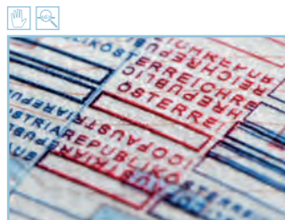
33. Schablonen-Einfärbetechnik Mehrfarbiger Stichtiefdruck 33. Schablons multiple colouring process Multi coloured intaglio printing
