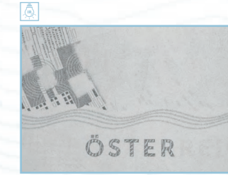
42. Infrarot Absorption Ein Teil des Stichtiefdrucks ist nicht sichtbar unter IR Licht 42. IR dropout A part of the intaglio printing is not visible under IR light
