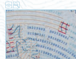
32. Infrarot Absorption Ein Teil des Drucks ist nicht sichtbar unter IR Licht 32. IR dropout A part of the print is not visible under IR light
