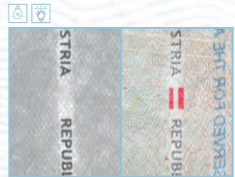
57. Sicherheitsstreifen Österreich-Flagge ist nicht sichtbar unter IR Licht 57. Security thread The Austrian flag is not visible under IR light
