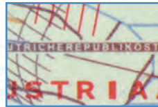
30. Mikroschrift negativ Mikroschrift negativ im Irisdruck 30. Microtext negative Negative microtext in rain- bow colouring (printing)
