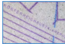
29. Mikroschrift positiv Positive Mikroschrift mit Linienmodulation 29. Microtext positive Positive microtext with line width modulation (LWM)
