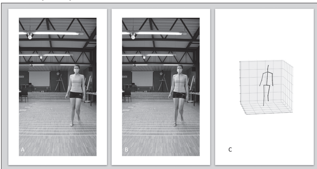
Abb. 8: Frameworks AlphaPose und MotionBERT – Anwendung der Frameworks auf Videomaterial aus der COMBI-Studie. A – Darstellung eines Beispielframes und B – abgeleitetes Rig mit AlphaPose. C stellt das Ergebnis von MotionBERT dar.
