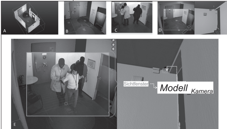
Abb. 2: Gesamtmodell: Zusammenführung des 3D-Modells des Tatortes, des Modells der virtuellen Kamera und der Superposition des Tatvideos. A: Gesamtübersicht Modell des Tatortes, B: Modell des Tatortes mit Blick auf den Tresorraum, C: Tatvideo, D: Virtuelle Kamera und Sichtfenster der Kamera mit Video auf den Tatort, E: Zusammenführung von 2D- und 3D-Informationen.
