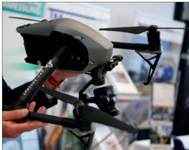
Drohne für die Vermessung bei Sprengensätzen.
