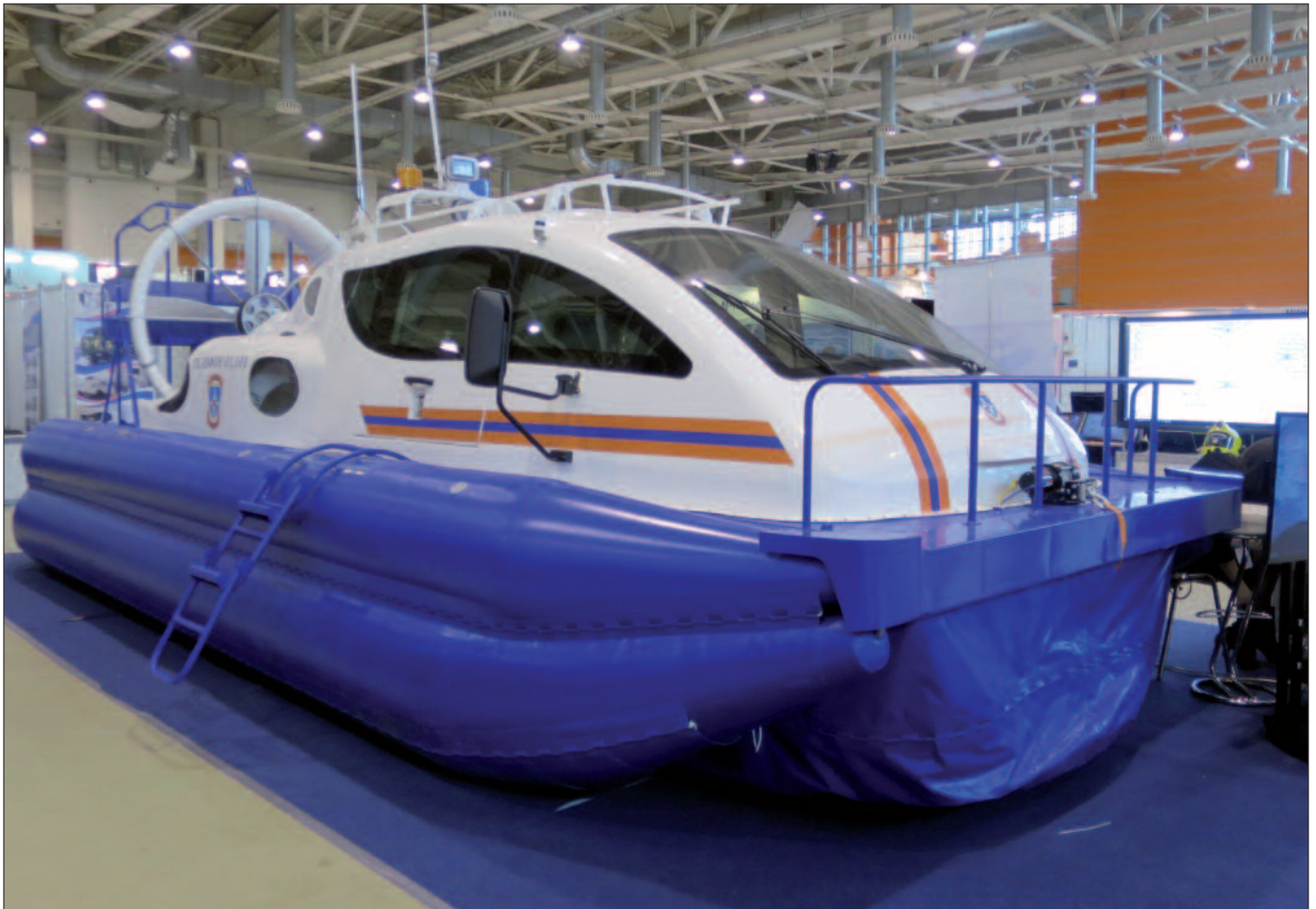
Luftkissenboot für Polizei-, Grenzschutz und Militäreinsätze: Auf Eis und Schnee ist das Fahrzeug bis zu 90 km/h schnell.
