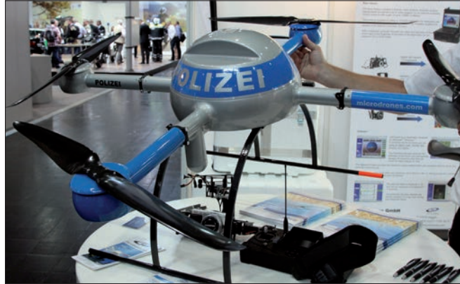
Mikrodrohnen für den Polizeieinsatz können über eingeebnete GPS-Koordinaten selbstständig eine Route abfliegen.
