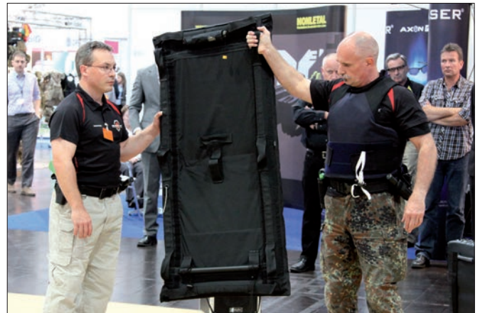
Ballistische Schutzdecke: Schutz vor Projektilen aus Faustfeuerwaffen.
