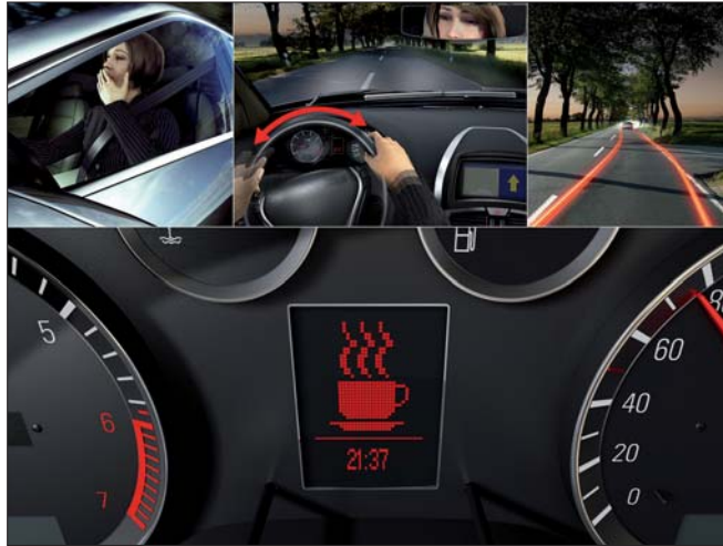
Kampf dem Sekundenschlaf: Das Müdigkeitserkennungssystem von Bosch erkennt an den Lenkbewegungen die zunehmende Müdigkeit des Fahrers und empfiehlt eine Pause.
