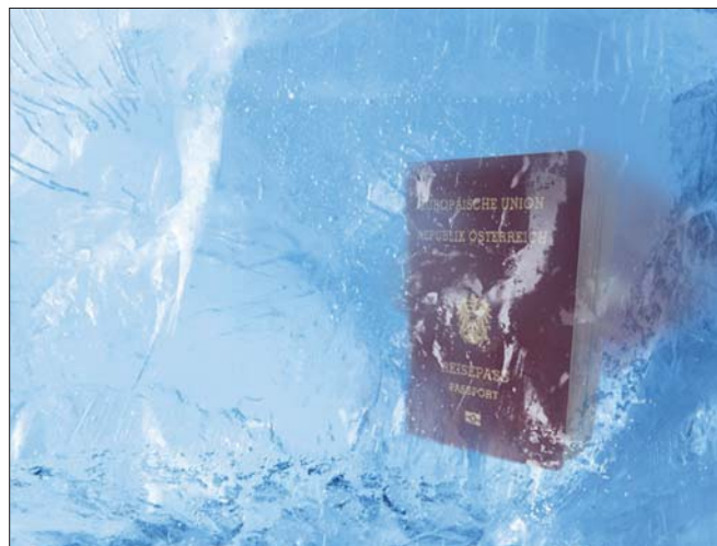
OeSD-Klimakammer: Test des österreichischen Reisepasses unter extremen Witterungsbedingungen.
