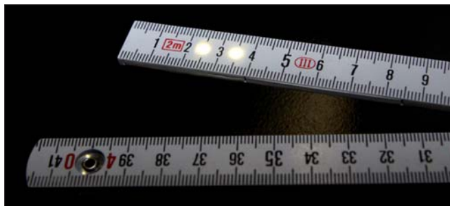
Leuchtmeter: Zwei Leuchtdioden in einem Gliedermaßstab.
