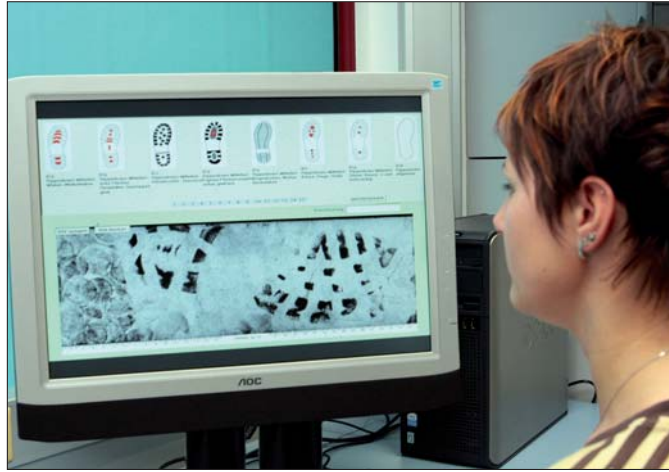
Schuhspurenabgleich: Das Programm entwickelte ein Kriminaltechniker in Tirol mit einer Softwarefirma.
