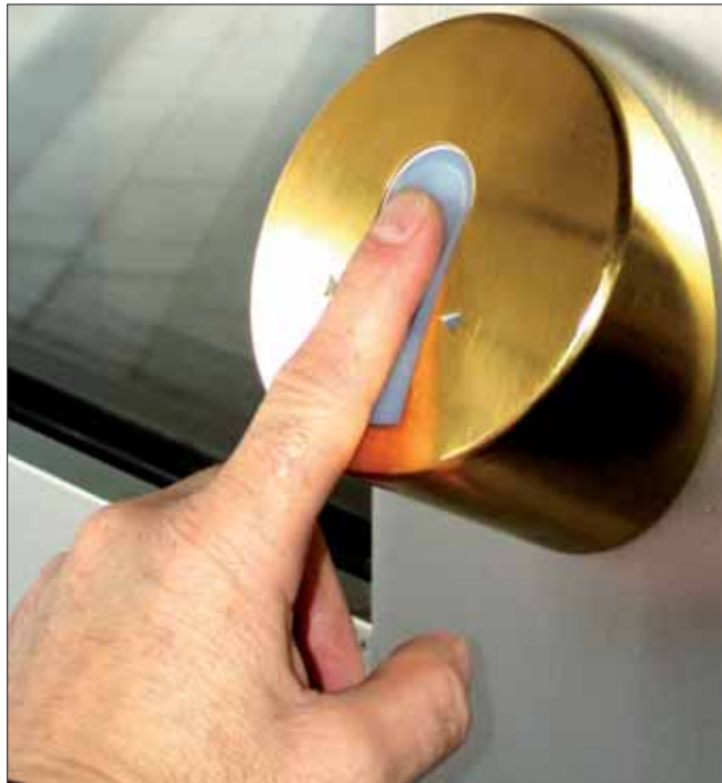
Biometrische Zutrittskontrolle: Fingerprint ist eines der am geeignetsten Verfahren.
