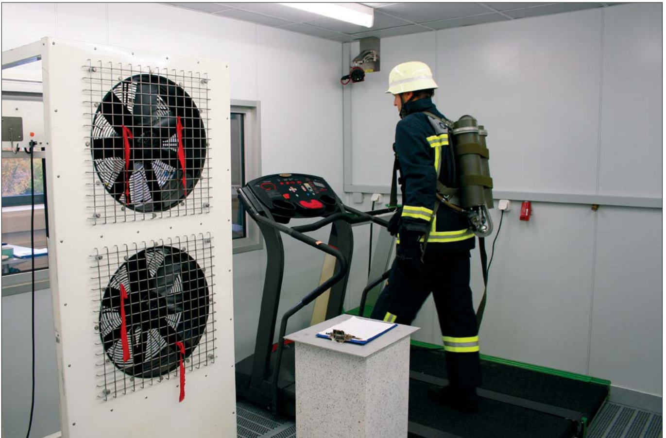
Klimakammer: Kleidungstests bei arktischer Kälte bis zu tropischen Stürmen.
