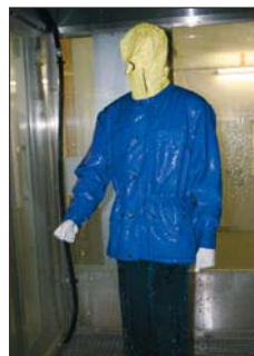
Regenkammer: Sturm und Wind werden simuliert.
