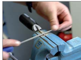
An den Druckmarken feilen, bis keine mehr sichtbar sind.
