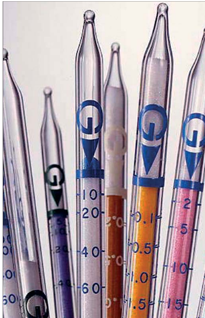
Gastec Tubes (Gasprüfröhrchen): Ermöglichen eine schnelle Messung von Gefahrenstoffen.
