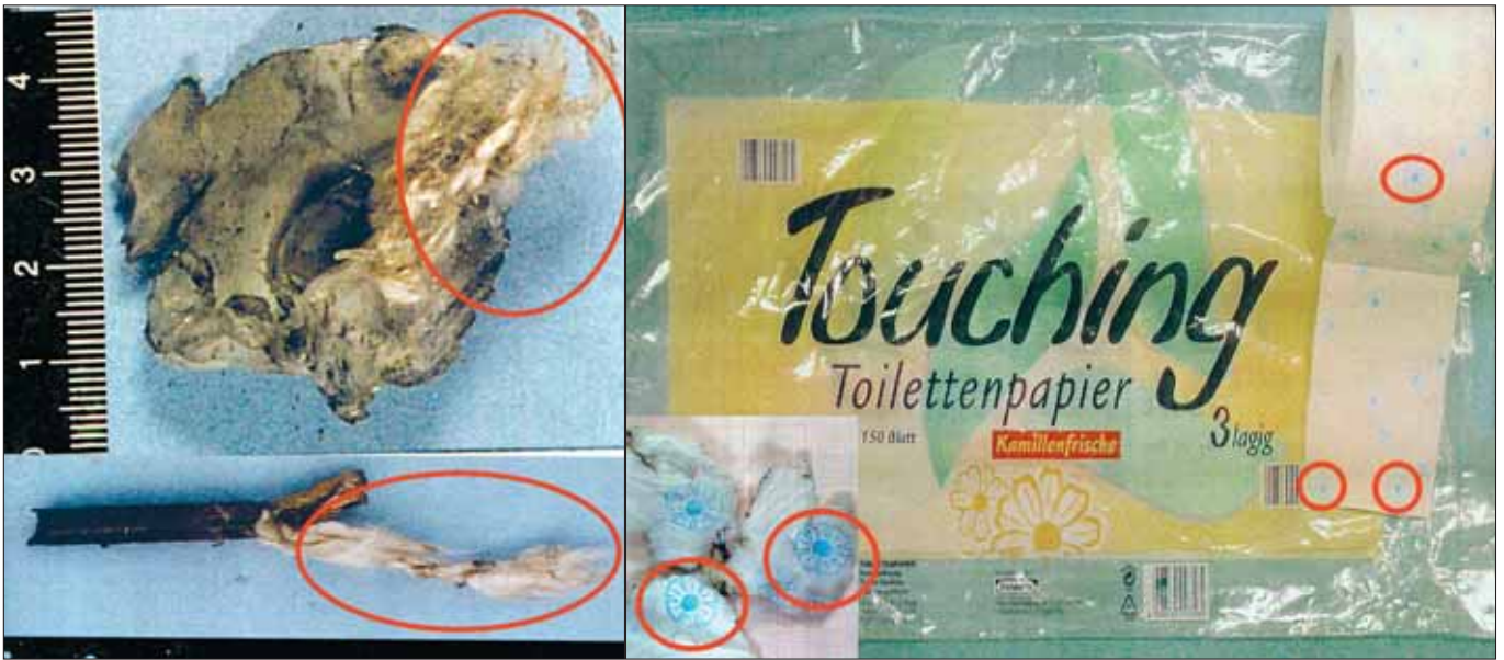
Zündschnur: Baumwollgarne in der Schraubverschlussöffnung des Modellbahnöfläschchens.
