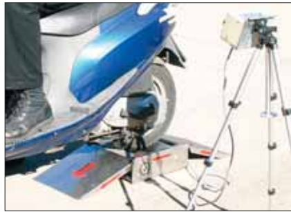
Mobiles Prüfgerät stellt Tempo der Mopeds auf die Probe.
