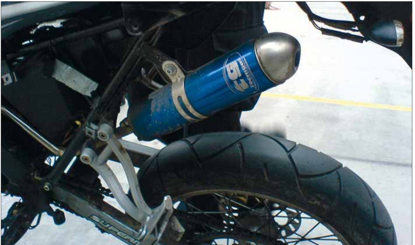
Drossel entfernt, Spezialauspuff, Spezialvergaser, Spezialzylinder – und das Moped fährt 120 km/h.
