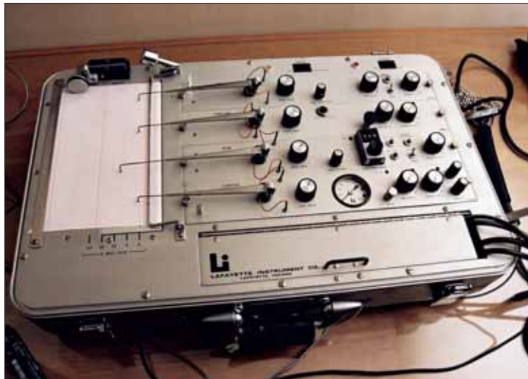
Polygraphen messen Körperreaktionen, die der Mensch nicht beeinflussen kann, etwa Schweißausstoß oder erhöhte Herzfrequenz.
