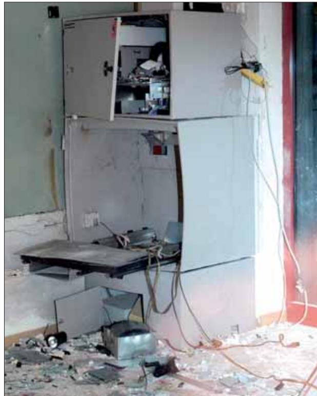
Mit Gas gesprengter Geldausgabeautomat.
