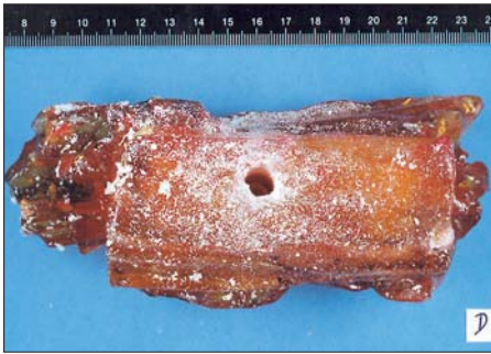
Kopal, der wegen seines verdächtigen Geruchs angebohrt wurde (Bild links). Der auffällige Kopal im Durchlicht: Im Innern sind unnatürliche Einlagerungen als dunkle Stellen zu erkennen (Bild Mitte). Das Innere des Kopals nach dem Aufschneiden. Die rosa und weißen Stellen bestehen aus Polyesterharz mit unterschiedlichem Anteil an Kokain (Bild rechts).
