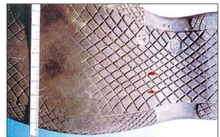
Das Profil des rechten Schuhs des Piloten. Es stimmt mit dem Abdruck auf dem Pedal überein.
